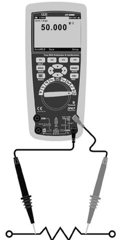
Sie können zur automatischen Kompensation des Messleitungswiderstands auch die REL-Funktion heranziehen: Messspitzen kurzschließen, Wert mit REL (MENU -> REL) als Referenz speichern, bei den folgenden Messungen ist der Leitungswiderstand eliminiert.
